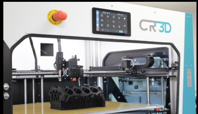
Nativer Not-AUS und ein 7 Zoll Touch Display für eine einfache Bedienung
