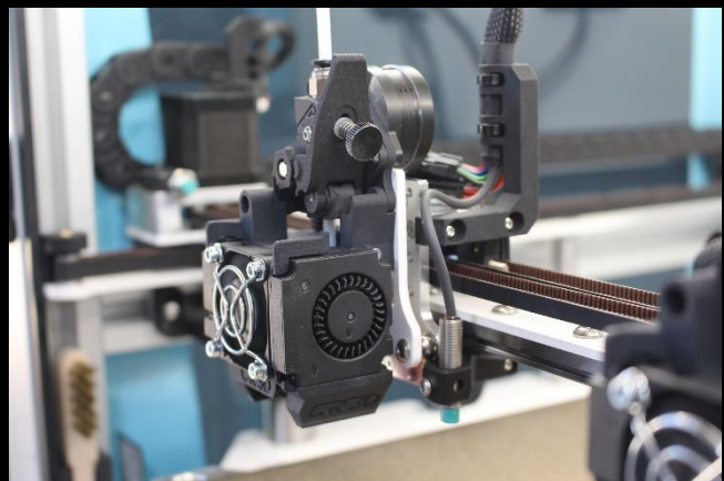
Optimiert bis ins Letzte Bauteil, des NanoTool montiert auf dem Druckkopf-Schnellwechselsystem
